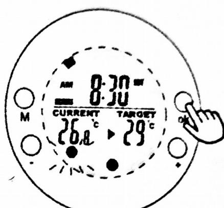
**Přístroj je řízený termostatem** – symbol „ON“ se zobrazením cílové teploty.
